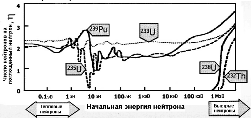
Рис. 12. Число нейтронов, возникших при поглощении одного нейтрона, \eta , для ^{233}\text{U} и других изотопов в зависимости от энергии нейтронов.
